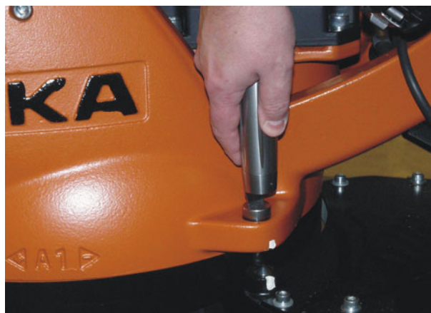
Abb. 5-7: Schutzkappe der Messpatrone entfernen
