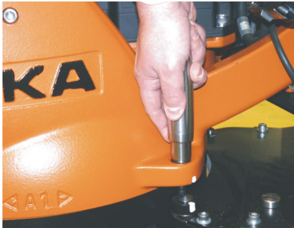
Abb. 5-8: EMD auf Messpatrone schrauben
