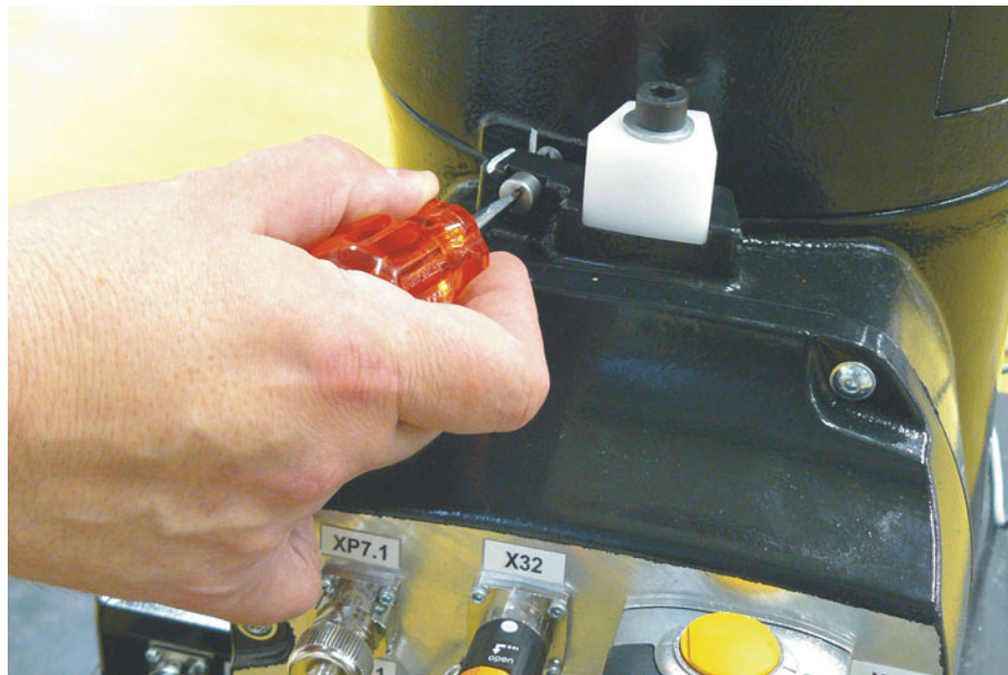
Abb. 5-15: Schutzkappe der Messpatrone entfernen
