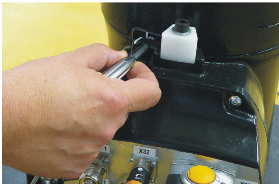
Abb. 5-16: MEMD auf Messpatrone schrauben
