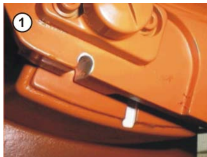
Abb. 5-3: Achse in Vorjustagestellung verfahren
